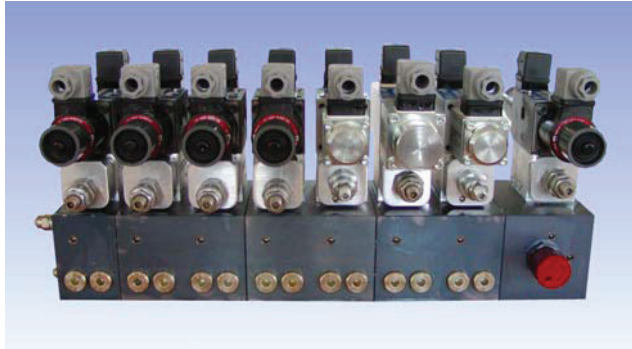
Abb. 8-fach LRF-Block NG 6 mit Schalt- und Proportional-Wegeventilen, bestehend aus (v.r.n.l.): 1x Grundblock GR, 3x Doppelblock DP und 1x Einzelblock P.
