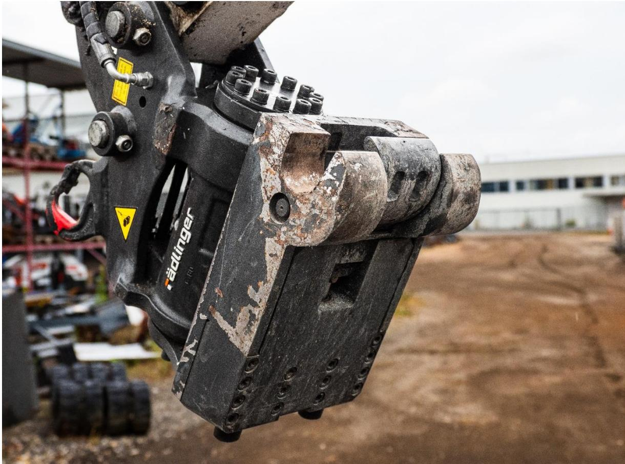
Caption: Quick-coupler systems for excavator attachments by Rädlinger Maschinen- und Stahlbau GmbH
